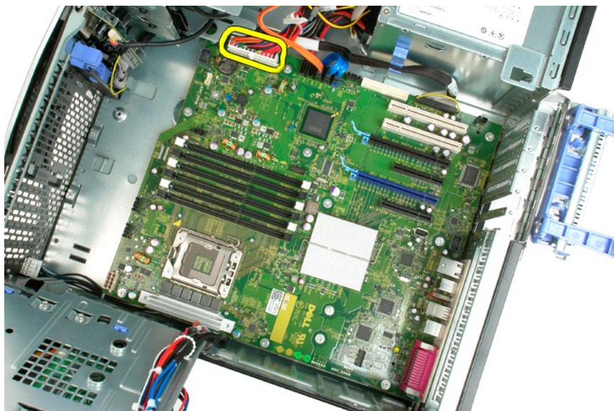
12. オプティカルドライブとハードドライブのデータケーブルを外します。
